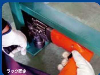
▶ 360°回転ヘッドが自由に動くため、コーナー部分や空間の狭い箇所での施工に最適 (SD-270C-LH、SD-333C-LH)
